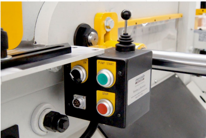
2 consolas de operación (delantera y trasera) con accionadores tipo joystick.
