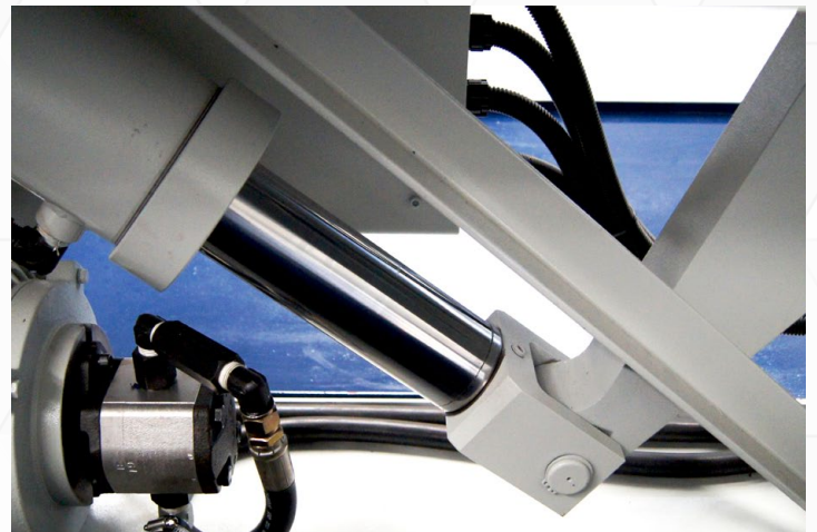
Pistones de acero forjado, endurecidos y rectificadas a precisión.
