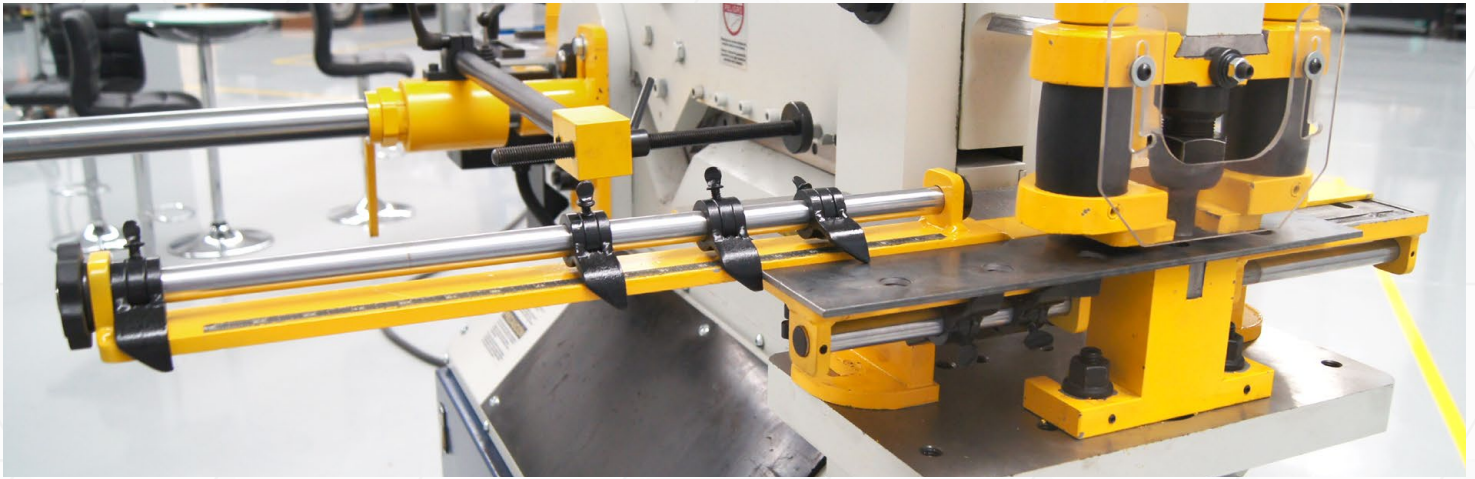
Mesa de reposicionado rápido con topes abatibles (escantillones) para punzear agujeros múltiples en solera.
